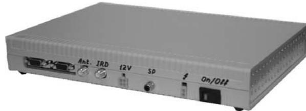
Контроллер обеспечивает связь антенны со спутниковым приемником, а также подает необходимое напряжение питания на другие компоненты системы.
