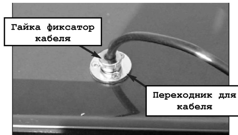
9. Закрепите болты в опорной шайбе изнутри автомобиля.
