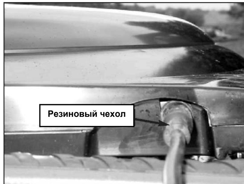
3. Выберите место на крыше под отверстие 12.5 мм. для входа кабеля. Внутри автомобиля снимите обшивку под крышей для доступа к месту сверления отверстия.
