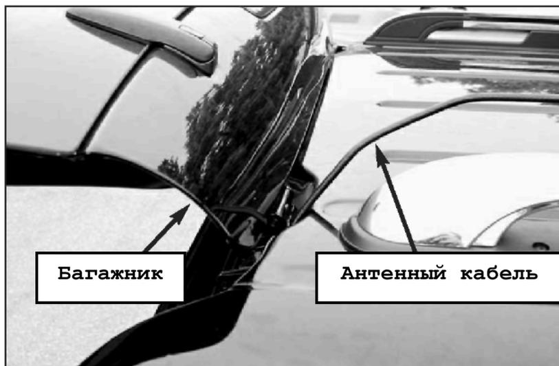
3. При помощи гаечного ключа на 12 мм. подключите кабель к разъему антенны.
