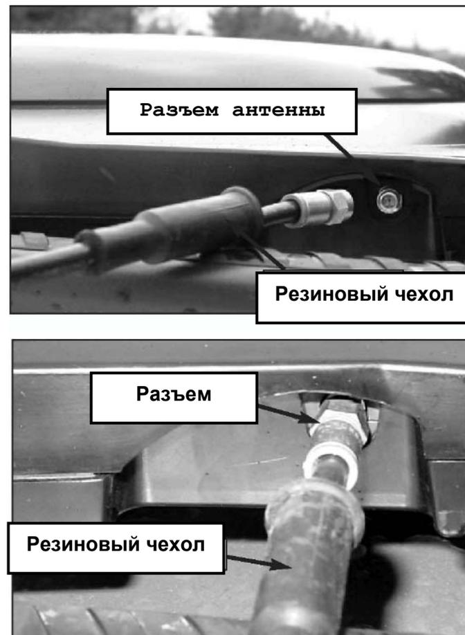
4. Сдвиньте резиновый чехол вдоль кабеля так, чтобы он полностью закрыл разъем. Этот чехол защитит разъемное соединение от грязи и воды.
