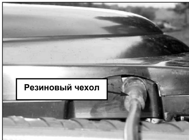
5. При необходимости с помощью стяжек из комплекта запчастей, или аналогичных, закрепите кабель на продольных направляющих крыши.
