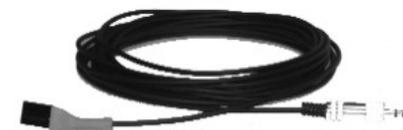
Приемник пульты ДУ принимает команды дистанционного управления и подает их на спутниковый ресивер.
